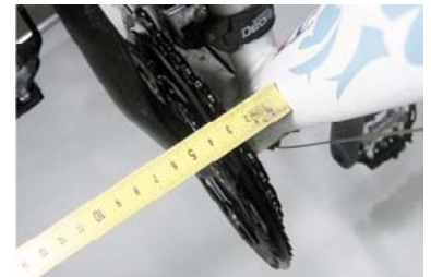
Schritt 6 Original Kettenführung wiederherstellen. Kettenlinie 3ter Gang: 54.5mm Kettenlinie Motorkette: 63.5mm
