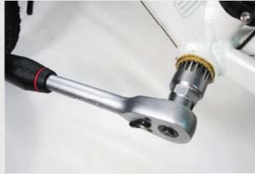
Schritt 2 Demontage des Tretlagers.
