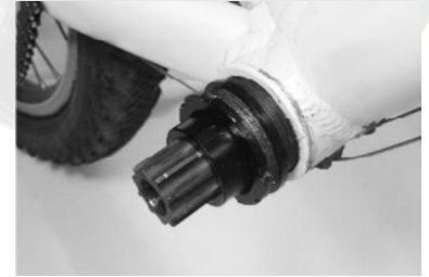
Schritt 3 Montage des neuen Tretlagers. Der Ring kommt auf die rechte Seite.
