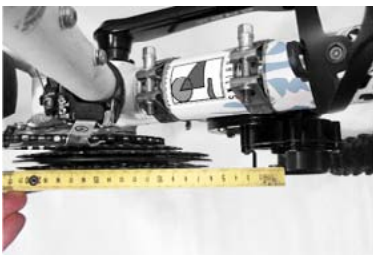
Schritt 7 Der Motor kann seitlich im Halter verschoben werden um die Kettenlinie einzustellen. Mit einer Leiste kann dies überprüft werden.
