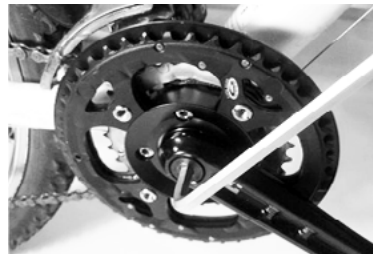
Schritt 5 Anbringung der Freilaufkurbel Sets Anzugsmoment max. 48N/m
