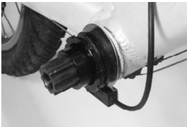
Schritt 4 Anbringung des Pedelec Sensors. (Falls vorhanden)
