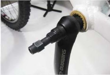
Schritt 1 Demontage der Kurbelarme.
